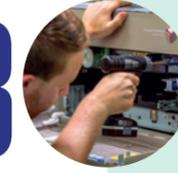
Dann wird die Maschine auf einem normalen Fabrikationsband wieder zusammengebaut, wobei sowohl bestehende als auch neue Teile verwendet werden. Festplatten werden gelöscht und neu formatiert und das System erhält das aktuelle Firmware-Update. Die Zähler werden auf Null gesetzt und die Maschine erhält neben der brandneuen Seriennummer auch eine neue Produktgarantie.
